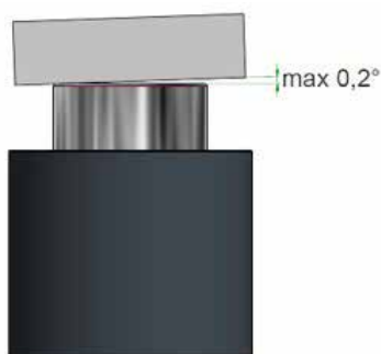
A carga está colocada incorretamente
