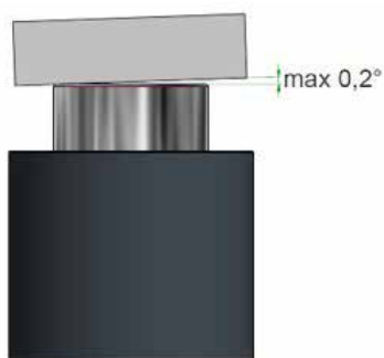
Belasting is los geplaatst
