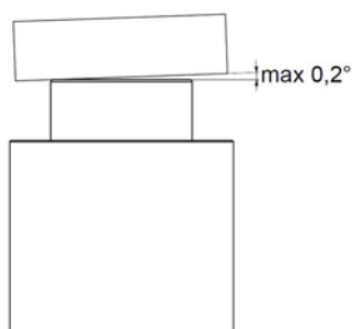
Figuur 1: Belasting rust los
